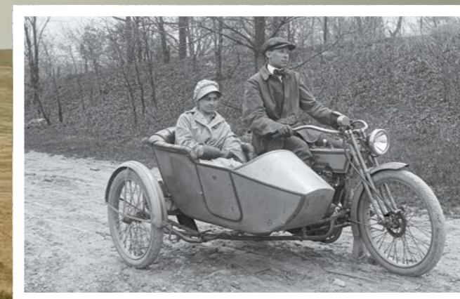
Le Touring au début du 20 ème siècle – La moto est un modèle 11F de 1915 équipé d'éclairages électriques et d'un modèle 11-L de side-car.
